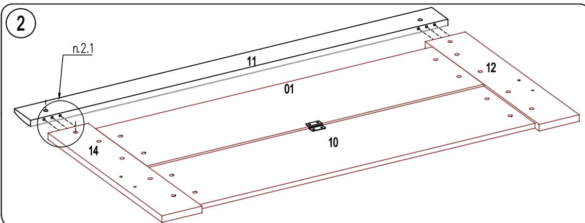
ориентация стяжки C5 – показана на рис., после сборки с дюбелем В4 стяжку затянуть по стрелке, затем установить самоклеющиеся заглушки Z2
